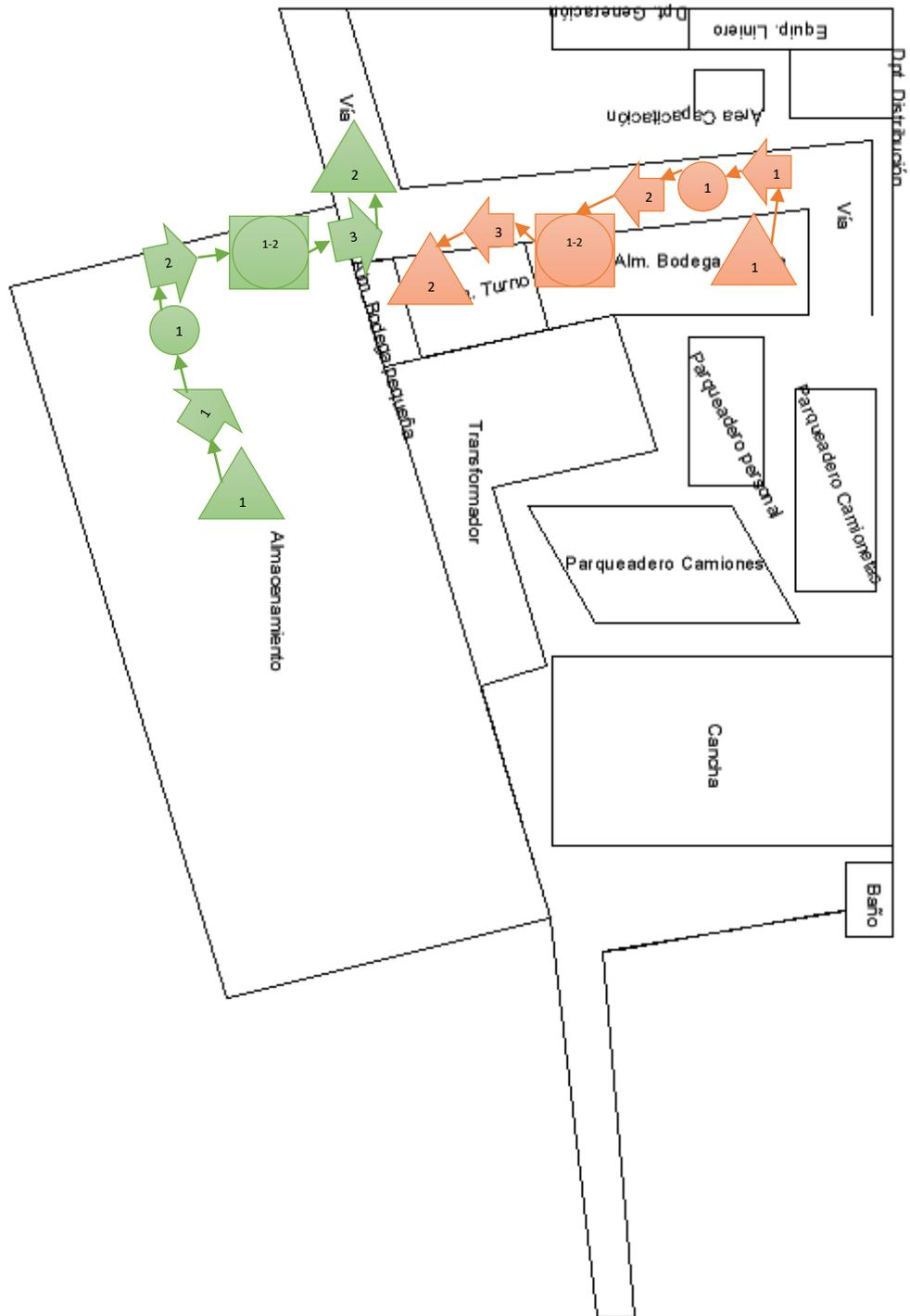
**Figura 40.** Diagrama de Recorrido de Recopilado y Salida de MP de los Departamentos de Generación y Distribución
