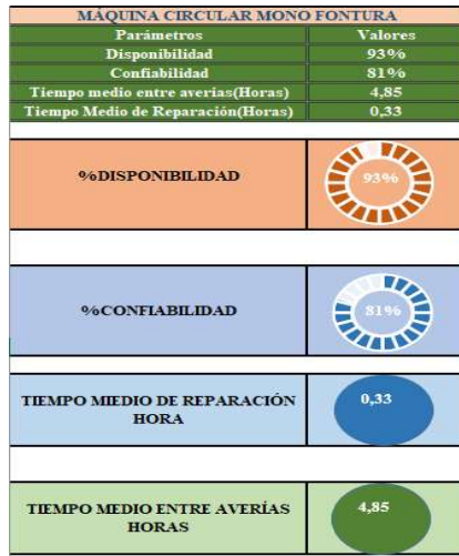
Figura 184. Indicadores de la máquina mono fontura de disponibilidad, %fiabilidad, tiempo medio de reparación y tiempo medio entre averías.
