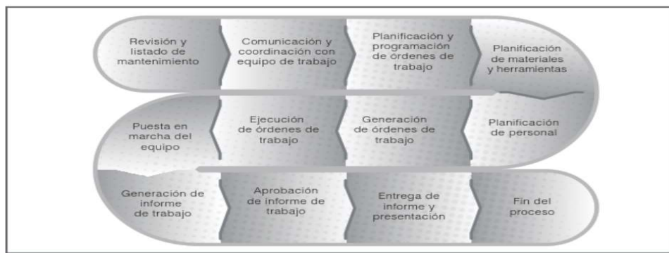
Figura 6. Proceso a seguir en el mantenimiento correctivo
