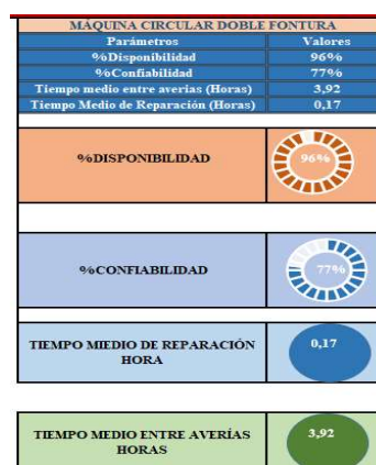
Figura 186. Indicadores de la máquina doble fontura de disponibilidad, %fiabilidad, tiempo medio de reparación y tiempo medio entre averías.
