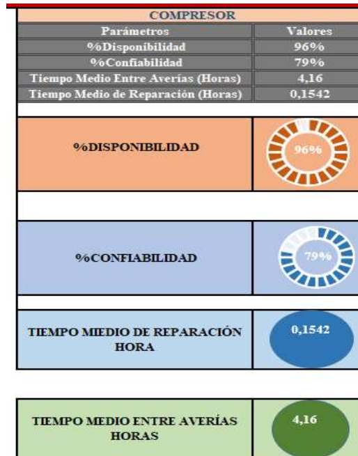
Figura 187. Indicadores del compresor de disponibilidad, %fiabilidad, Tiempo medio de reparación y Tiempo medio entre averías.
