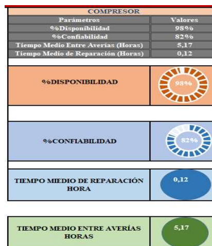
Figura 188. Indicadores del compresor de disponibilidad, %fiabilidad, tiempo medio de reparación y tiempo medio entre averías.
