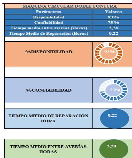
Figura 185. Indicadores de la máquina doble fontura de disponibilidad, %fiabilidad, tiempo medio de reparación y tiempo medio entre averías.
