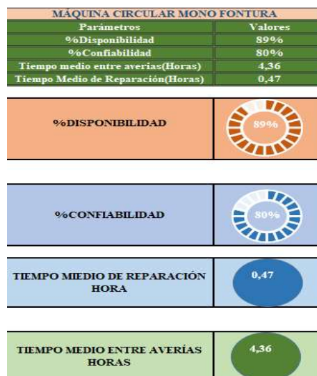
Figura 183. Indicadores de la máquina mono fontura de disponibilidad, %fiabilidad, tiempo medio de reparación y tiempo medio entre averías.
