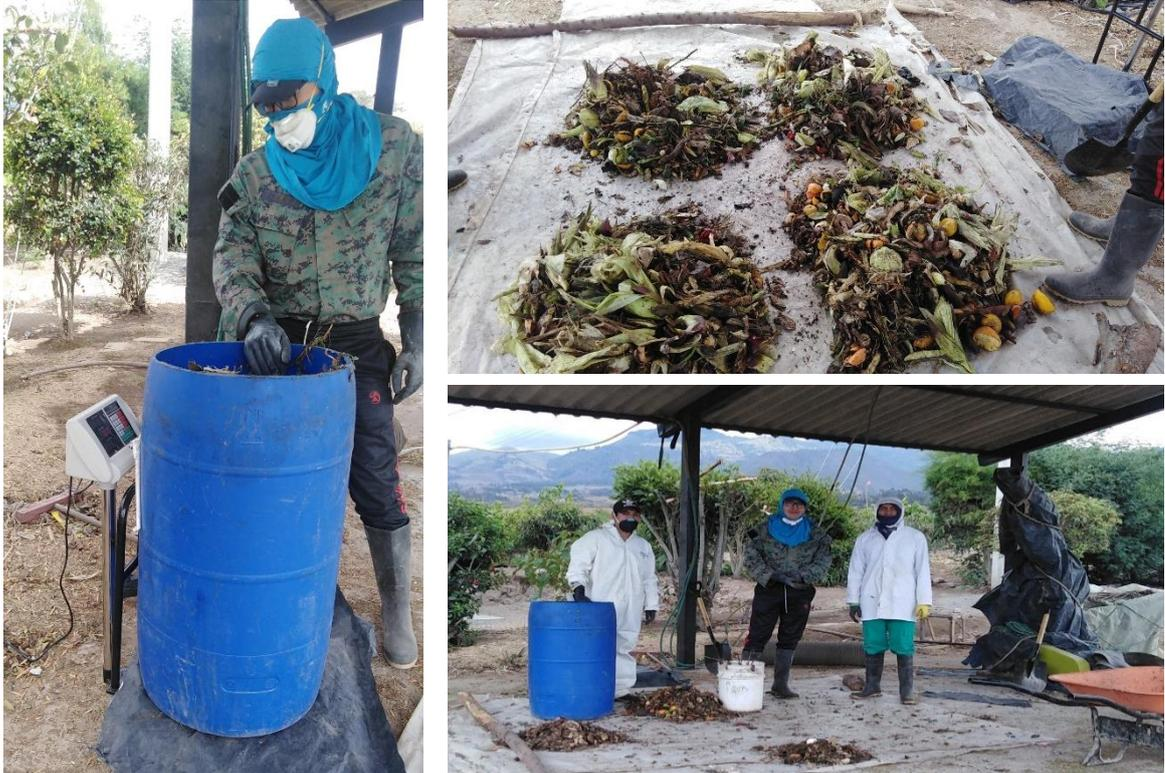
*Nota:* Se muestra el método del cuarteo, también los recipientes y equipo utilizado para obtener el peso volumétrico, además las medidas de seguridad como son: guantes, mascarilla y un overol.
