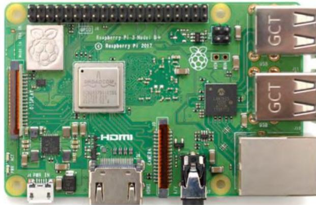
Figura 7. Sistema embebido *Raspberry*
