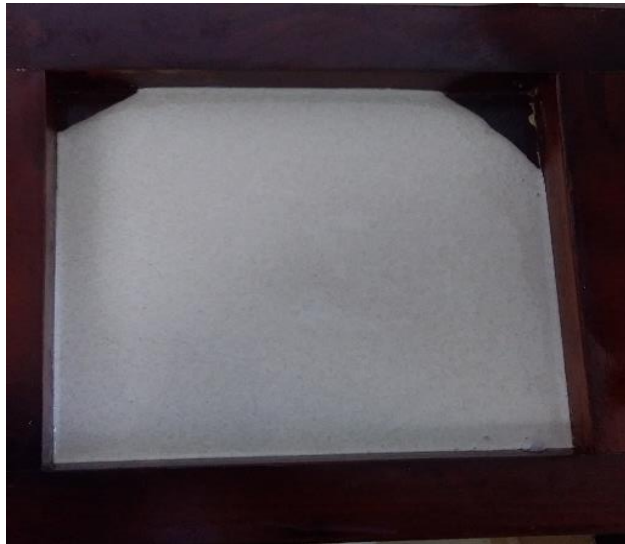
Figura 33. Colocación de la mezcla en el marco (base de tríples)
