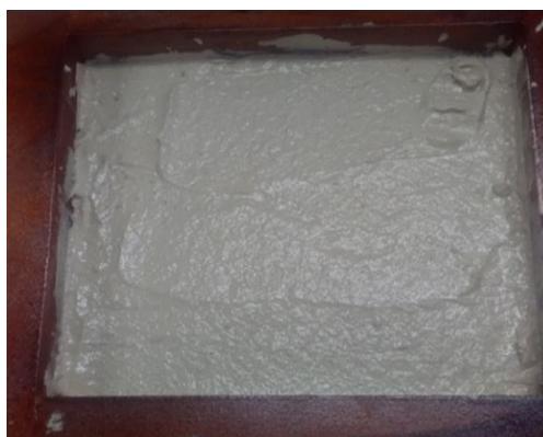
Figura 31. Colocación de la mezcla de celulosa y látex
