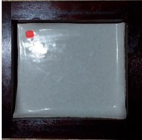
Figura 36. Estabilización y secado al ambiente silicona Artesil RTV
