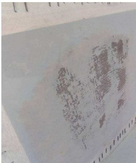
Figura 23. Paso de la silicona (Fafsoft) a través de la malla de estampación
