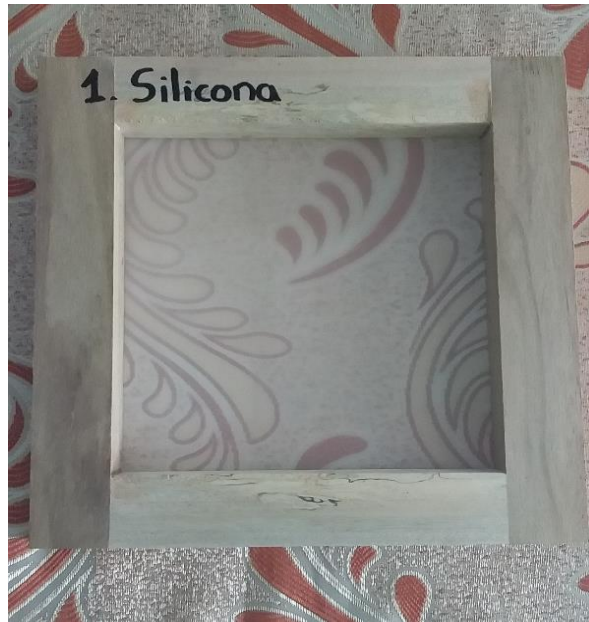
Figura 21. Marco de serigrafía para silicona
