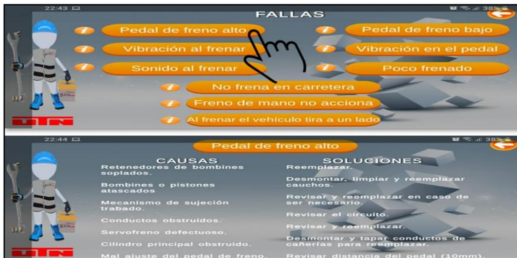
**Figura 3.30** Panel fallas y soluciones
