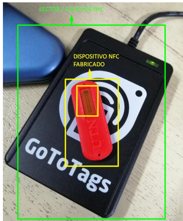
Figura 57. Lector/Escritor junto con tag NFC fabricado
