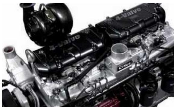
**Figura 1.7** Motor de ciclo Diésel
