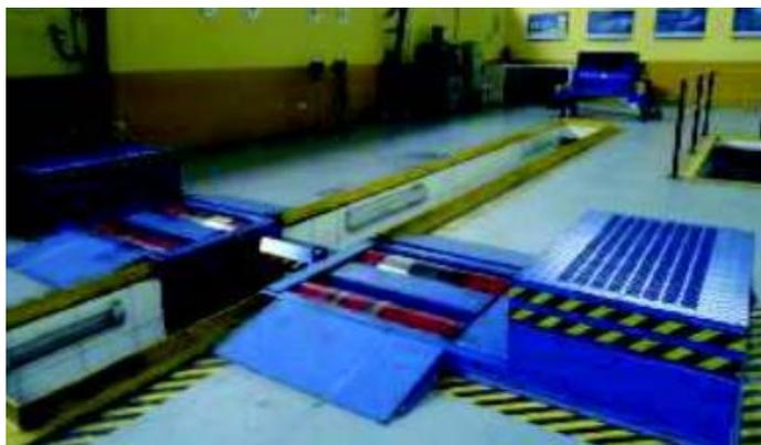
**Figura 1.17** Dinamómetro de chasis LPS 3000 con sus componentes
