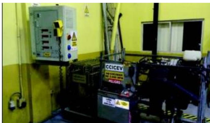
**Figura 1.16** Dinamómetro de motor
