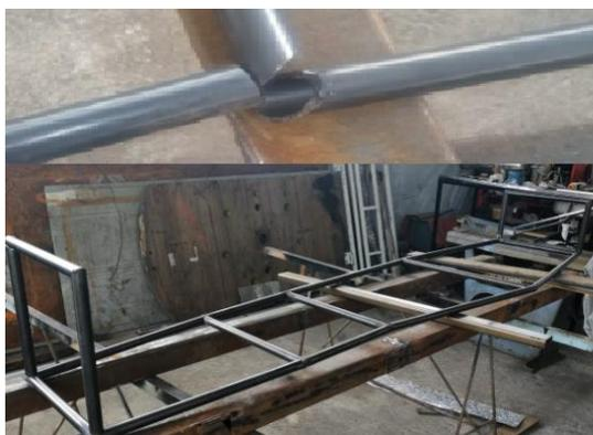
**Figura 2.7** Piso bastidor
