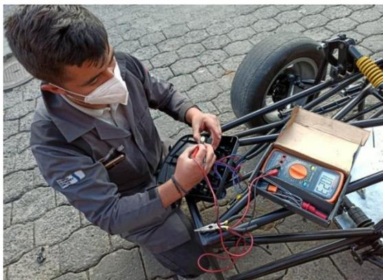
**Figura 2.23** Instalación y sustitución del potenciómetro de aceleración
