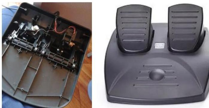
**Figura 2.22** Pedal de aceleración con potenciómetro
