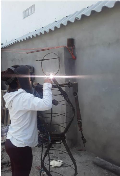
Figura 30. Suelda de varillas para dejar estático el rostro de la escultura
