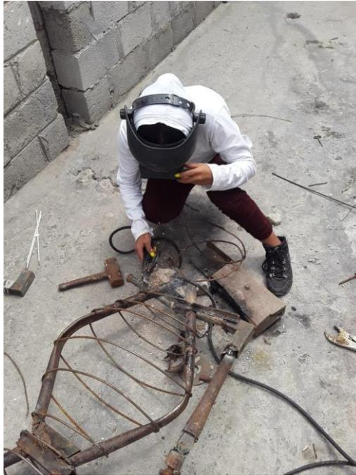
Figura 31. Suelda las extremidades superiores del brazo
