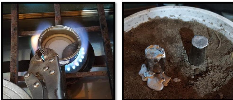
Figura 1. Fabricación de prototipo de proyectiles
