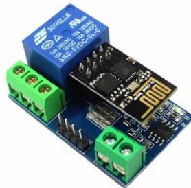
Figura 22. Módulo relé Wi-Fi.
