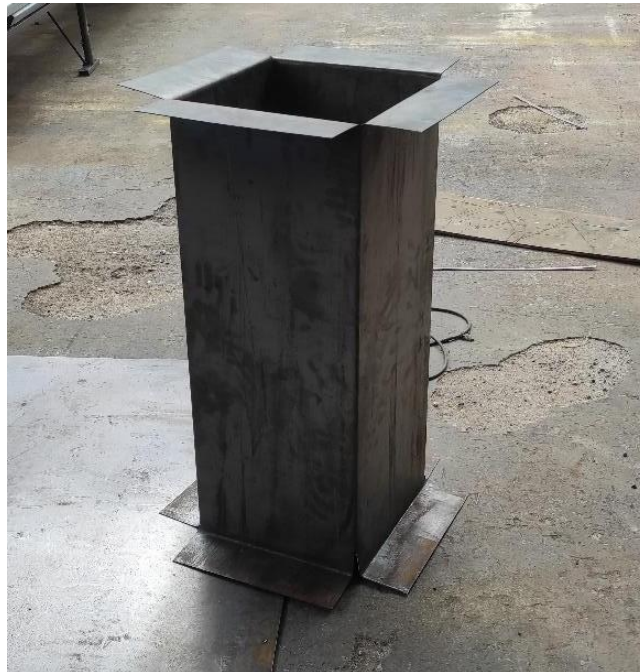
Figura 37: Ducto de caída libre
