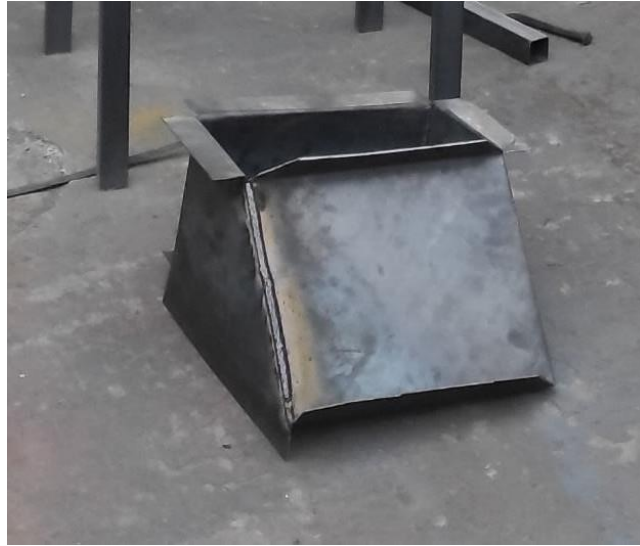
Figura 36: Tolva de salida de materiales livianos
