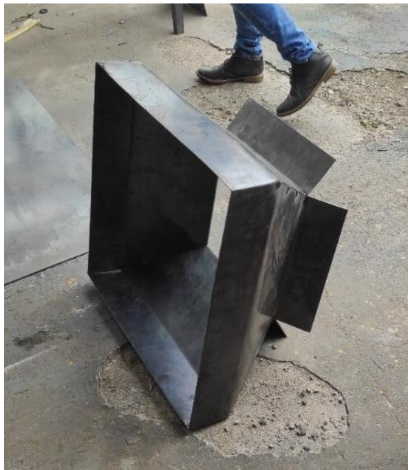
Figura 35: Construcción tolva de ingreso
