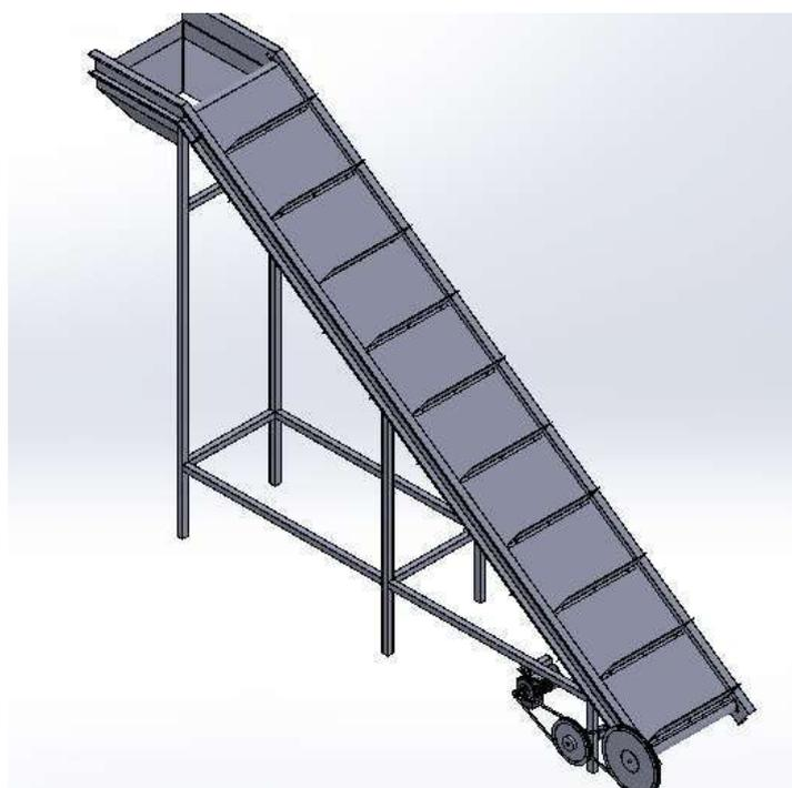
*Figura 17. Sistema de transporte de residuos sólidos*
