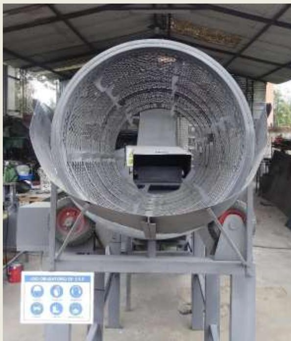
El sistema de Cribado mecánico por medio de sus cuchillas y el movimiento giratorio, permite abrir las bolsas de basura y a su vez separar los desechos por tamaño.
