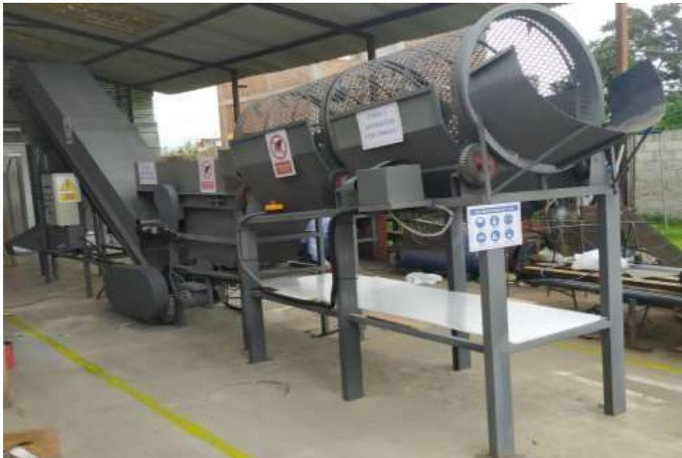
*Figura 44. Construcción del sistema de clasificación de residuos sólidos domésticos*
