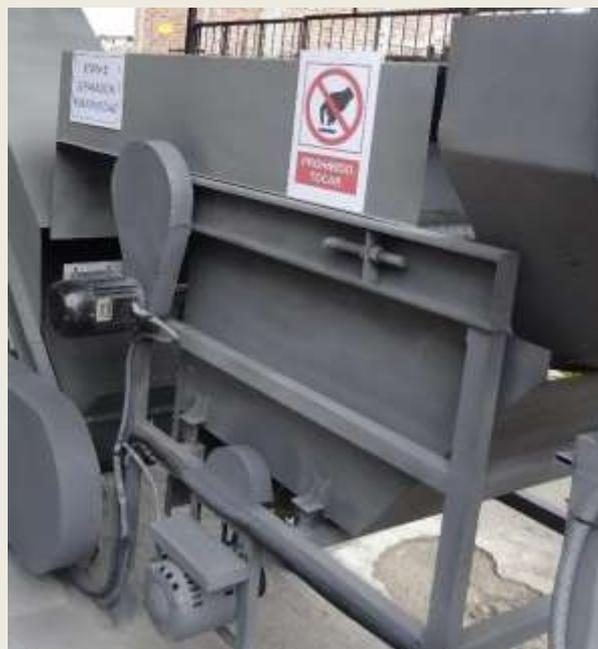
Este sistema funciona con un motor para estimular la vibración y con venteroles para emitir aire a una presión de 10 Bares.
