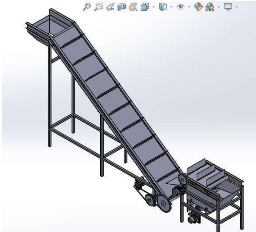
Figura 24. Sistema de separación de residuos sólidos.
