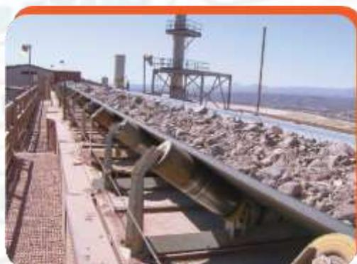
La longitud (metros), el ancho (pulgadas), espesor (mm) y las características especiales, también la combinación de ellas, ej. HR150 - SOR - SC - FR, que equivale a las siguientes especificaciones: Banda que resista hasta 150°C, además altamente resistente al aceite, anti-estática y retardante previo a encenderse con el fuego. Según las necesidades del cliente y la disponibilidad de nuestros fabricantes, podemos entregarlos en 4 hasta 8 semanas.
