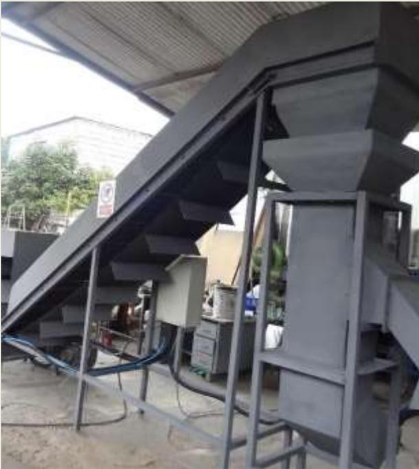
El sistema de transporte para su funcionamiento utiliza una banda que tiene acoplado cangilones que permiten transportar los desechos livianos al siguiente sistema.
