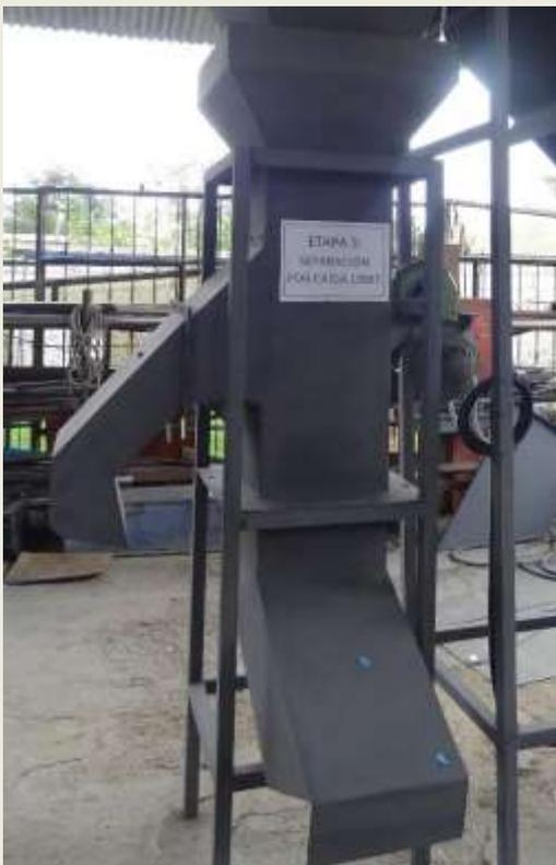
El sistema de separación de residuos sólidos mediante un sistema de aire y caída libre funciona por medio de la gravedad, permitiendo que los objetos más pesados caigan de manera libre por su ducto y los materiales menos densos por medio de aire tiendan a salir empujados del ducto de caída.
