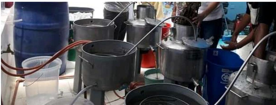
Figura 8. Planta extractora de aceites esenciales
