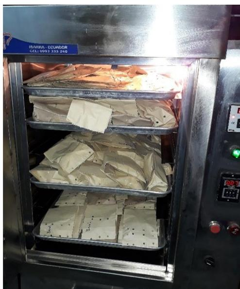
Figura 6. Secado de muestras en la estufa a 70 °C
