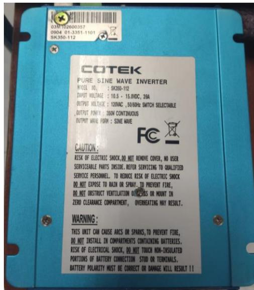
Fig. 19. Inversor de carga
