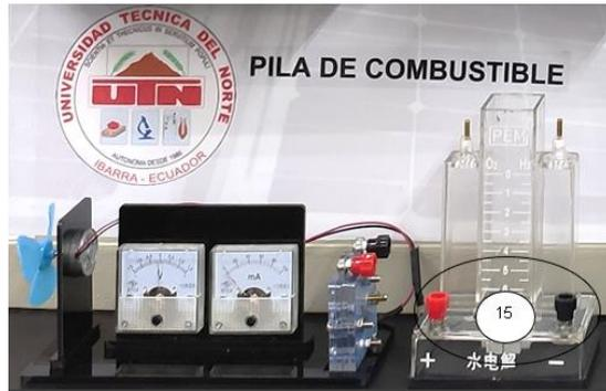
15) **Borneras de la pila de combustible:** Las borneras marcadas son las que se alimentan a 12V por al menos 2min para poder empezar a realizar la electrolisis en el recipiente de agua para atravesar por la manguera pequeña que está conectado a la pila de combustible.
