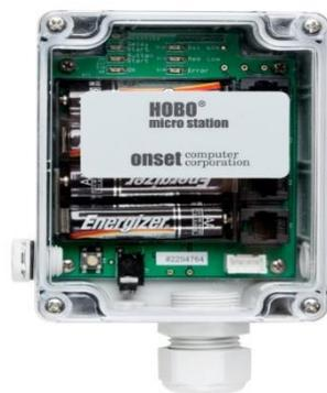
Para obtener los datos de radiación solar se conecta el puerto USB del Datalogger a una computadora mediante el software HOBOWare, ya que este dispositivo está conectado con el piranómetro instalado junto al panel solar en la parte superior, obteniendo así los datos en tiempo real.
