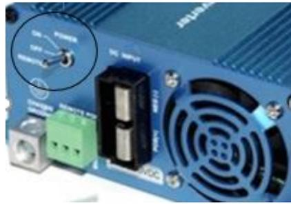
10) **Switch del inversor:** Desde aquí se controla el encendido y apagado del inversor, este dispositivo convierte el voltaje de 12VDC a 120VAC.
