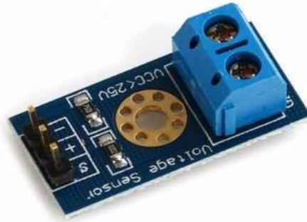
Fig. 50. Sensor de voltaje para Arduino
