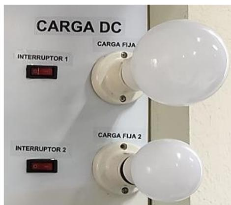
9) **Interruptores de conexión:** Los interruptores 1 y 2 nos permiten el encendido y apagado de los focos DC de 12 y 18W respectivamente.
