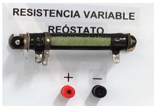
8) **Reóstato:** Más conocido como resistencia variable, se utiliza para regular la carga, es de 0 a 12 ohmios.
