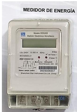
11) **Medidor de energía:** Es un visualizador del consumo de energía de las cargas de 120VAC.
