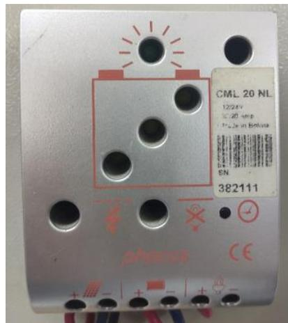
Fig. 18. Regulador de carga de 20A
