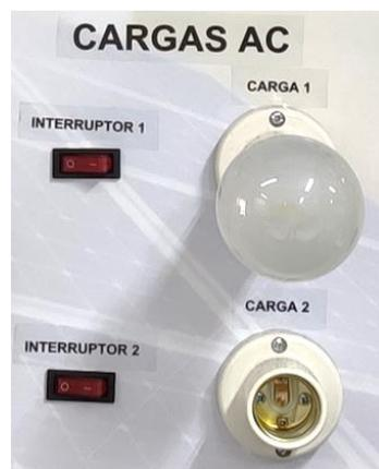
13) **Interruptor de cargas AC:** Estos interruptores 1 y 2 sirven para conectar y desconectar las cargas AC.
