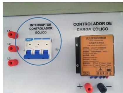
Fig. 7 Activación del interruptor trifásico para la conexión del controlador eólico
