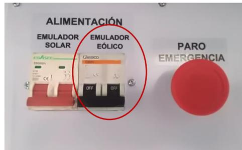
Fig. 3 Interruptores para encender los emuladores (eólicos / solar) y paro de emergencia
