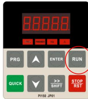
Fig. 5 Botón para iniciar el funcionamiento del emulador
