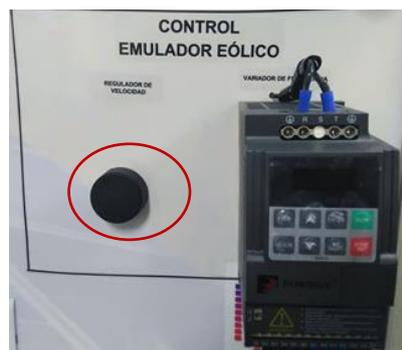
Fig. 6 Perilla de regulación de la velocidad del emulador eólico
