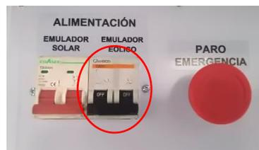
Fig.4 Encendido del emulador eólico
