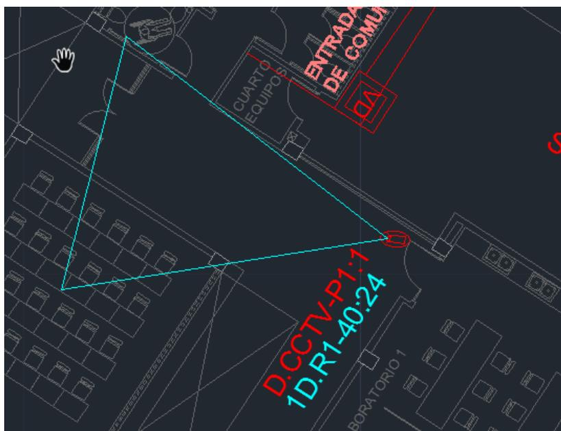
*Figura 46 Cobertura para Cámaras de CCTV para Exteriores en ITTS*
