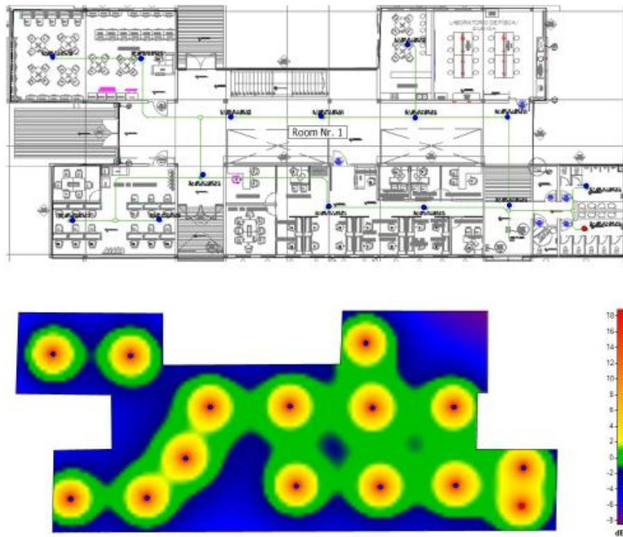
*Figura 56 Distribución de Parlantes en ITTS con software EASE*
