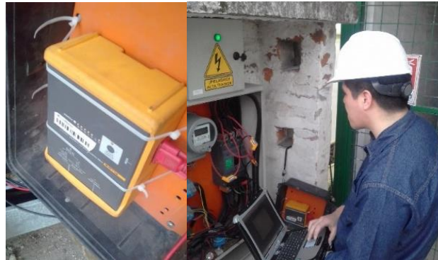
Fig. 2.11. Adquisición de datos de las mediciones eléctricas del suministro 228033-7. Fuente: el autor
