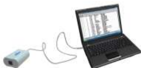
Fig. 30: Instalación de capturador de infrarrojos Fuente (HDL, 2021)
