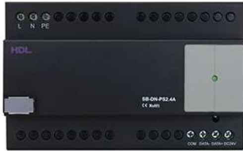
Fig. 21. Fuente de Alimentación. Fuente: (HDL Ecuador, 2018)
