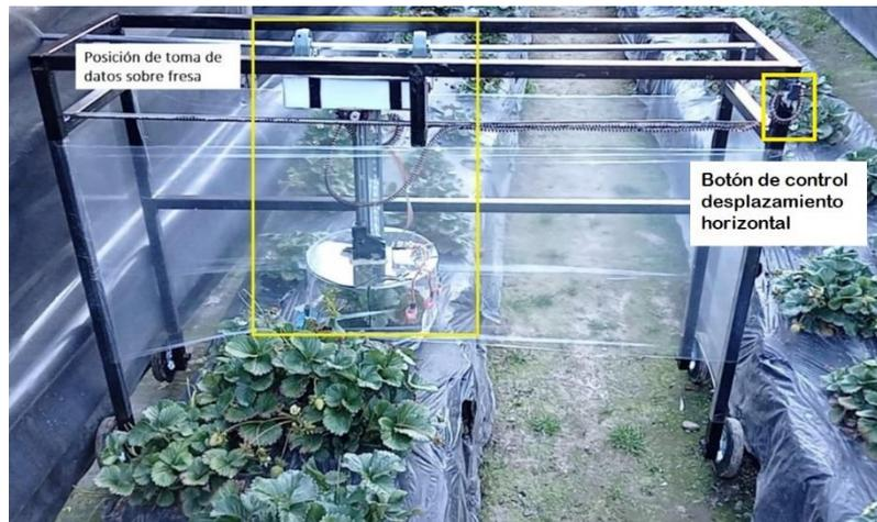
Figura. 7 Botón de control del desplazamiento horizontal y posición de toma de datos sobre la fresa.
