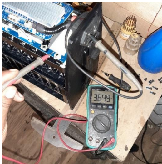
Figura 2.17 Voltaje de la celda con 100% de carga
