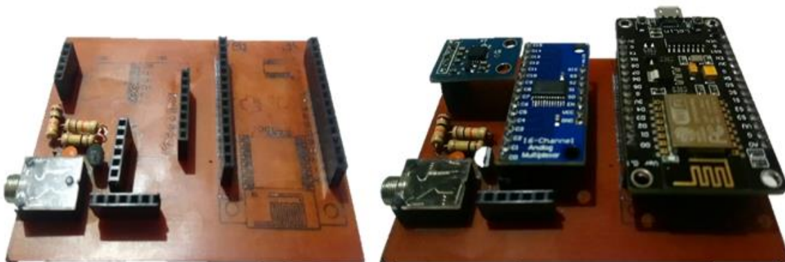
Figura 37. Implementación y acoplamiento de sensores a placa
