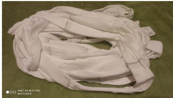
La tira que se obtiene luego del trabajo de la máquina tiene que ser desunida en calcetines individuales, esto es, que se tiene que cortar; este paso es importante en la línea de producción ya que con eso se puede pasar a las fases finales, que es donde se realizan los terminados para su posterior embalaje, almacenamiento y envío.
