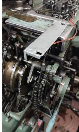
El segundo servomotor se lo ubico en la parte posterior, sostenida por tornillos; esto es, junto al tubo principal del Castillo, para que se mantenga cerca de la barra de activación del alimentador del elástico.
