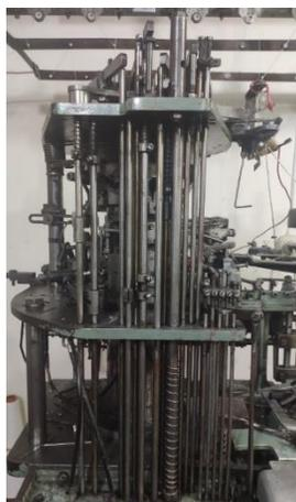
Las fases de funcionamiento de la máquina son en sí basados en un contador de eslabones, ya que, al estar sincronizadas para cumplir una función durante un tiempo específico, esta situación nos permite el poder controlar las fases de funcionamiento a través del sistema de control que se lo está implementando en este trabajo de investigación.
