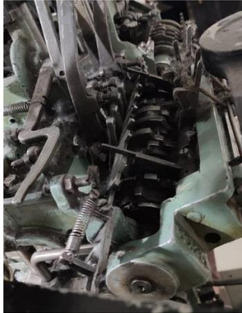
En la parte posterior de la máquina se colocó el sensor que servirá para enviar el mensaje de error, el cual está conectado al vástago del sistema de activación de fallas, este sensor enviará una señal hacia el controlador para que este muestre un mensaje de error en pantalla y hacer que la máquina detenga su movimiento, cada vez que exista una falla en los sensores de la máquina.
