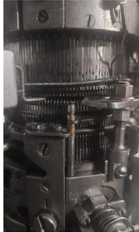
Se deja la cadena de manera plana, es decir, que la cadena ya no posee los eslabones con alza, sino solamente normales, los cuales nos permiten realizar el conteo para poder activar el cambio de fase de manera correcta. La cadena que se está usando como referencia está compuesta por 87 eslabones.
