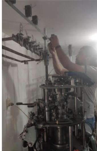
Los sensores de rotura de hilo luego de ser reparados se pueden ver de esta forma:
