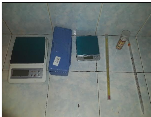
Anexo D3. Instrumentos utilizados (balanza gramera, refractómetro, balanza de precisión, termómetro, tiras para medir pH, pipeta volumétrica de 10 ml)
