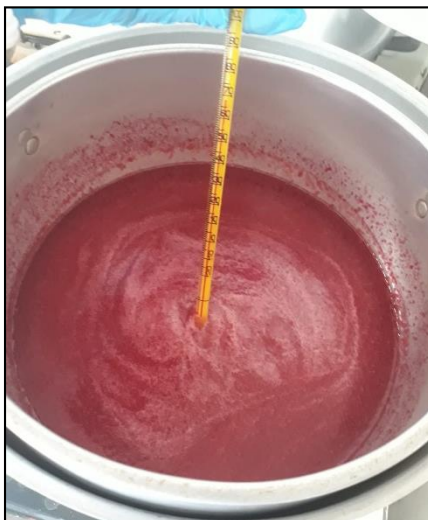
Anexo D12. Pasteurización del néctar a 95° C durante 10 minutos.
