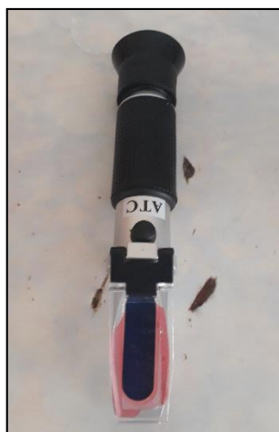
Anexo D8. Medición de °Brix inicial (2,4°) de la mezcla (néctar)
