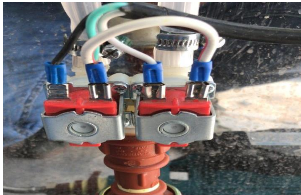
Fig.46. Electroválvulas. Fuente: (Autor,2021)
