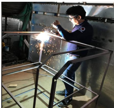
Fig.37. Estructura de ángulo. Fuente: (Autor,2021)
