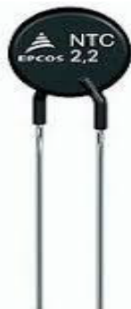
Fig.8. Termistor NTC. Fuente: (Lomas, 2019).
