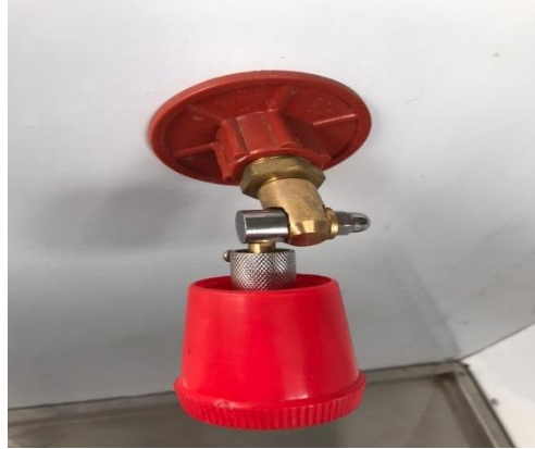
Fig.45. Aspersor cabeza giratoria. Fuente: (Autor,2021)
