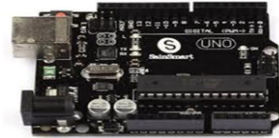
Fig.6. Arduino UNO. Fuente: (Aluisa, 2017)
