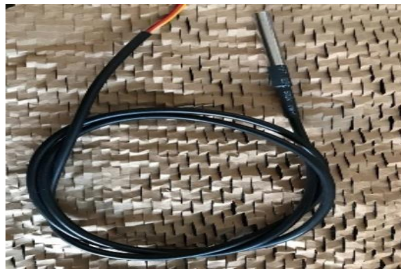
Fig.32. Termocupla HFT 600V. Fuente: (Autor, 2021)
