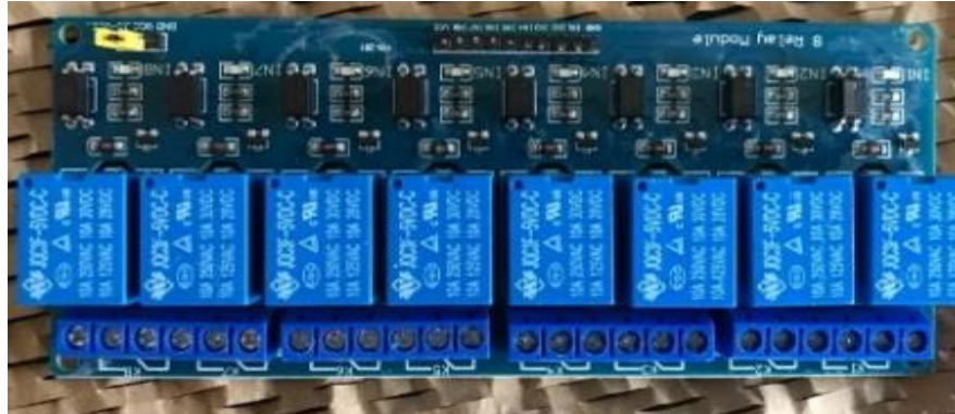
Fig.51. Módulo relé 8 vías. Fuente: (Autor,2021)
