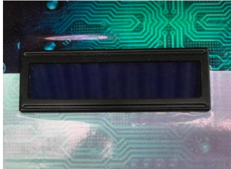
Fig.55. LCD 16X2. Fuente: (Autor,2021)
