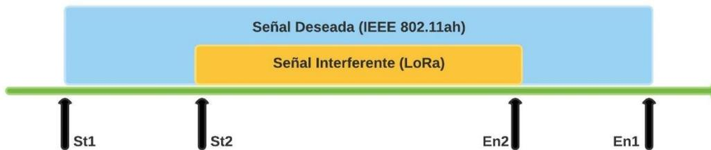
Figura 58. Caso 3: la señal interferente se transmite durante la señal deseada, sí hay solapamiento.
