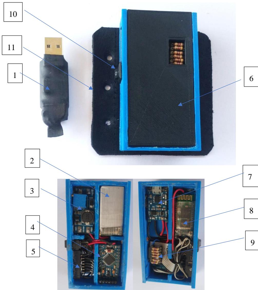
Figura 47. Dispositivo electrónico para la adquisición de datos de sensores de fuerza FSR.
