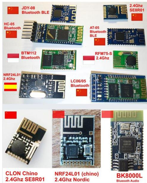
Figura 12. Módulos bluetooth existentes en el mercado para Arduino [24].
