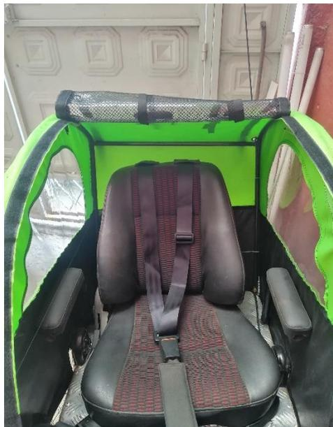
**Figura 2.16** Instalación de cinturón de seguridad
