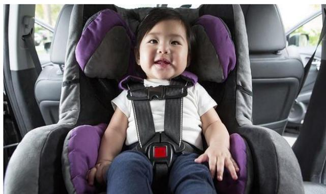
**Figura 1.16** Cinturón de seguridad tipo arnés
