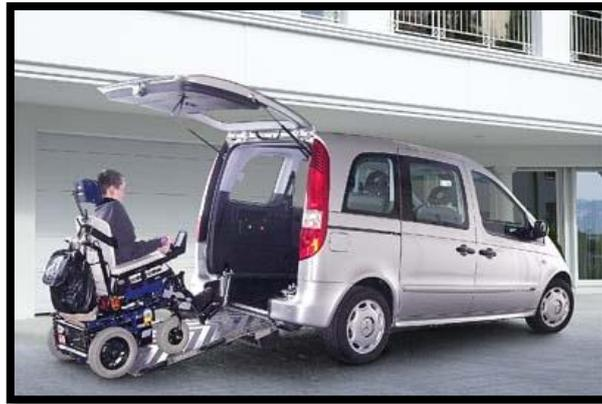
**Figura 1.3** Adaptación de rampa trasera
