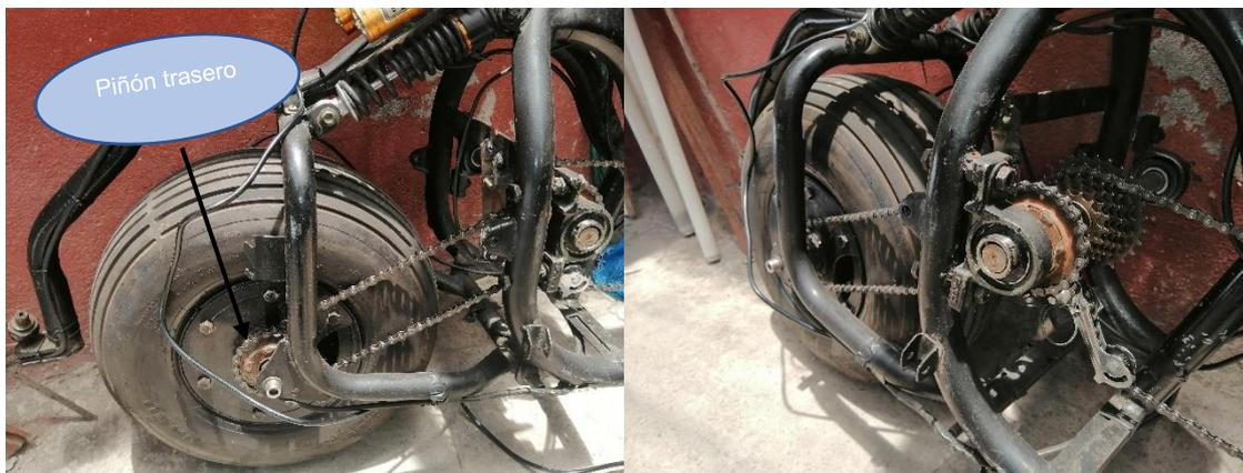
**Figura 2.18** Adaptación de sistema de pedaleo
