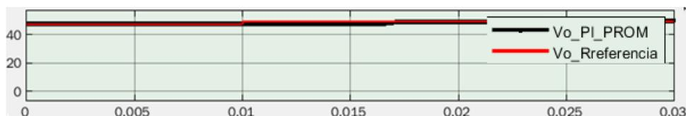
**Fig. 39b.** Respuesta temporal promediada del controlador PI en cascada ante variación de referencia.
