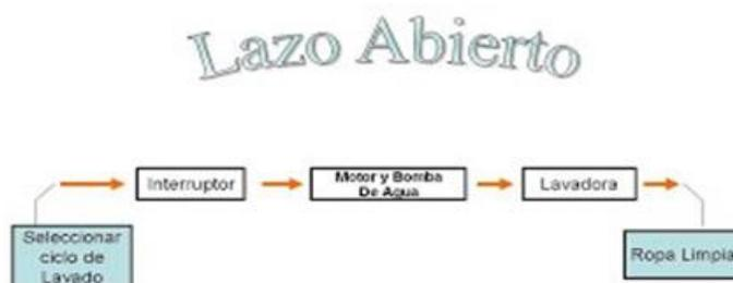
**Fig. 2.** Esquema de control Lazo Abierto.
