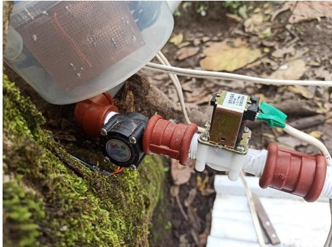
**Figura 30.** Instalación de la electroválvula y sensor de flujo
