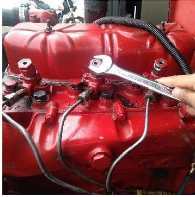
Figura 17 Calibración de inyectores
