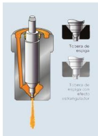
Figura 8 Inyector con tobera de espiga
