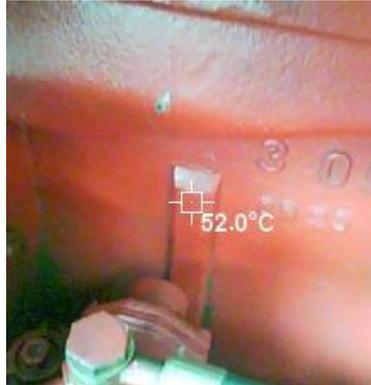
Figura 15 Toma de temperatura en el cilindro
