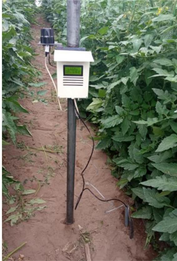
*Figura 34: Módulo de sensores Instalado en Invernadero*
