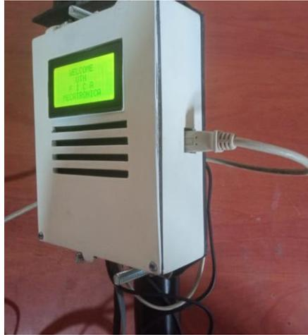
**Figura 48:** Conexión USB a Módulo
