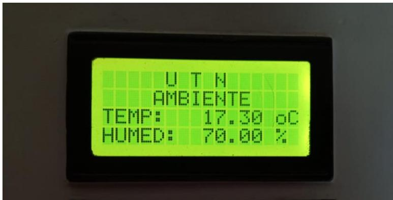
*Figura 35: Visualización de Temperatura y humedad relativa de Ambiente*
