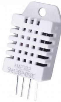
**Figura 6:** Sensor DHT22
