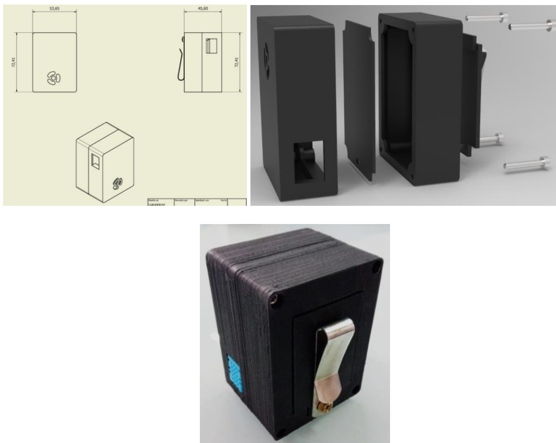
Figura 20. Integración de placa PCB en CASE
