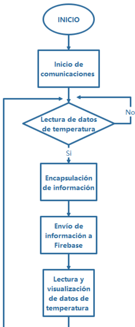
Figura 21. Diagrama de flujo para adquisición de datos del sensor.
