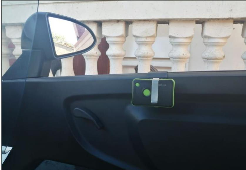
**Figura 3.7** Instalación del datalogger GPS en el vehículo Renault
