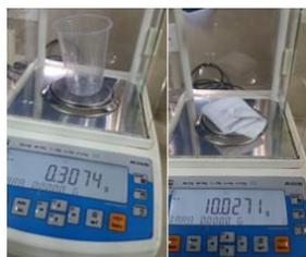
Nota: La Figura 15, indica el pesaje de auxiliares y ensayo textil, para seguir con el proceso de acabado textil y determinar su factor antibacteriano.
