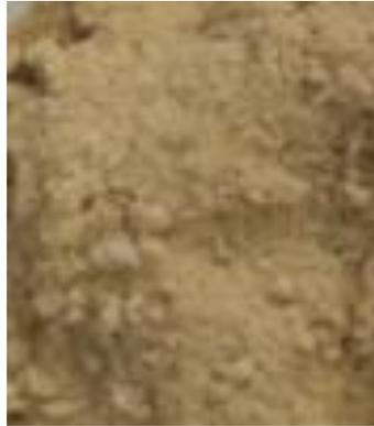
Nota: la Figura 12, muestra el aspecto de la celulosa después de finalizar el proceso de cocción y secado.
