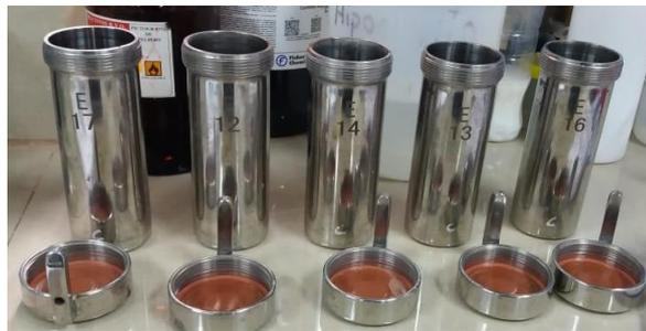
Nota: La Figura 16, muestra los vasos preparados con los químicos, celulosa y muestra textil, listos para colocar en la máquina autoclave.
