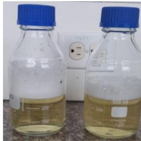
3. Tras al enfriamiento, se procede a pesar 45 gramos de solución, el cual se colocó en cada vaso y fue adicionado las muestras contaminadas individualmente. Después de un tiempo se debe añadir la solución contaminada en las placas Petrifilm (cada muestra contaminada se coloca en dos placas Petrifilm, dando a entender las 2 repeticiones), con la ayuda de una micropipeta.
