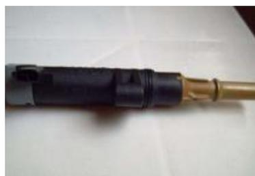
**Figura 1.14** Bobina de encendido en vehículos de gasolina
