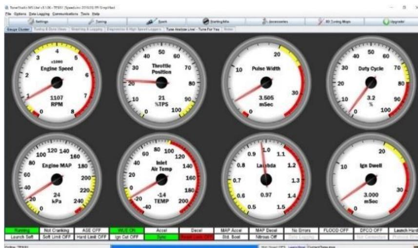
**Figura 3.46** Datos obtenidos en el Software TunerStudio prueba bobina
