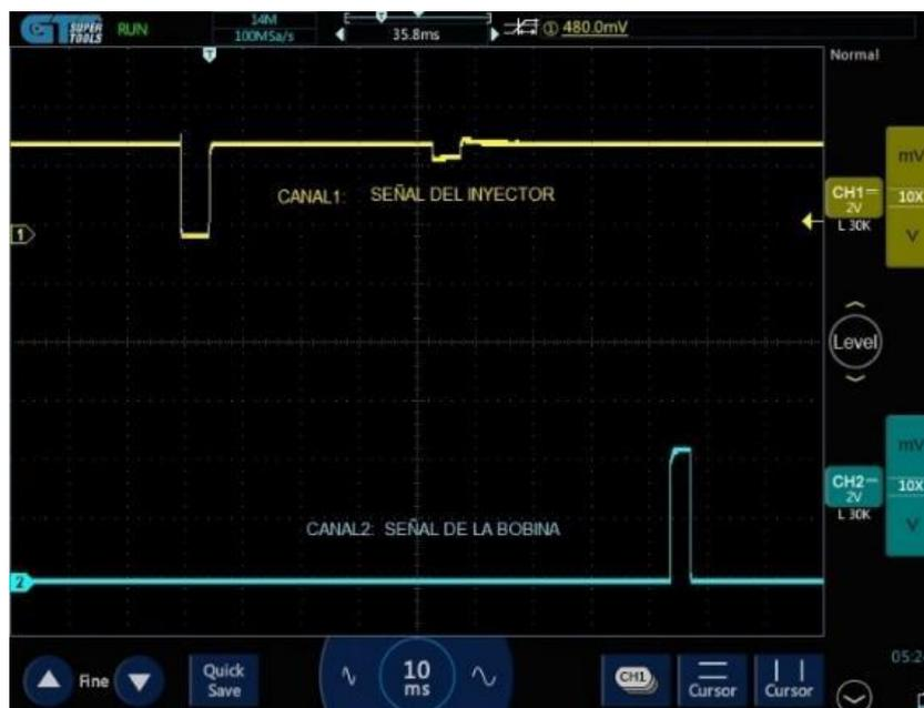
**Figura 3.38** Señal de bobina vs señal de inyector
