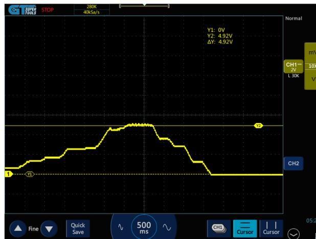
**Figura 3.26** Oscilograma de funcionamiento TPS
