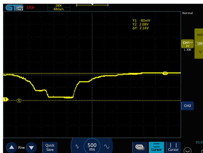
**Figura 3.29** Oscilograma de funcionamiento IAT
