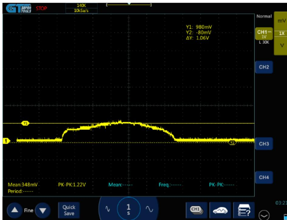
**Figura 3.57** Oscilograma de funcionamiento del sensor MAP con datos
