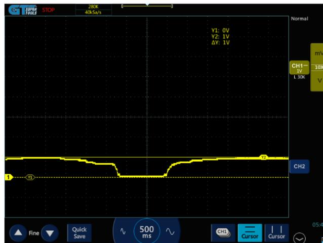
**Figura 3.28** Oscilograma del sensor ECT
