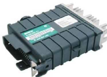
**Figura 1.7** Unidad de control electrónica (ECU)
