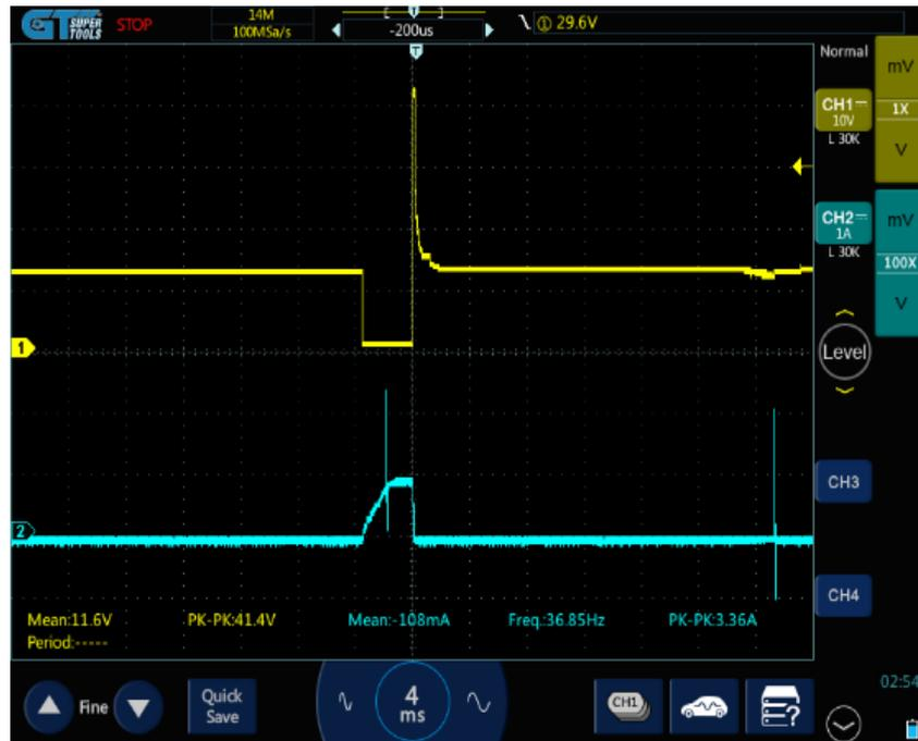
**Figura 3.48** Oscilograma de funcionamiento y consumo de inyector
