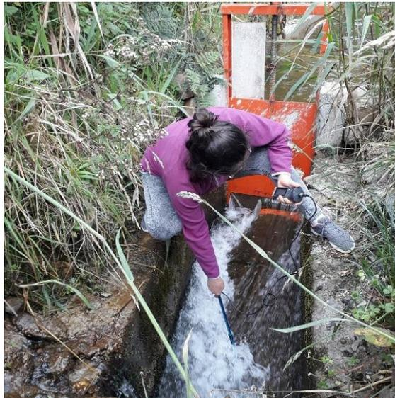
**Figura 7.** Aforo con moliente en el canal de Riego Monte Olivo-San Rafael
