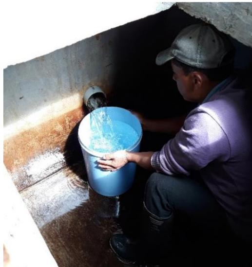
**Figura 6.** Aforo con método volumétrico en la fuente de agua de Monte Olivo “El Manantial”
