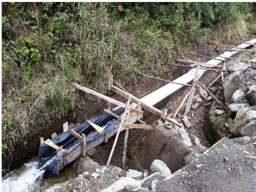
**Anexo 3i)** Estimación del caudal con aplicación del método volumétrico en la Vertiente “El Cuzumbe”.
