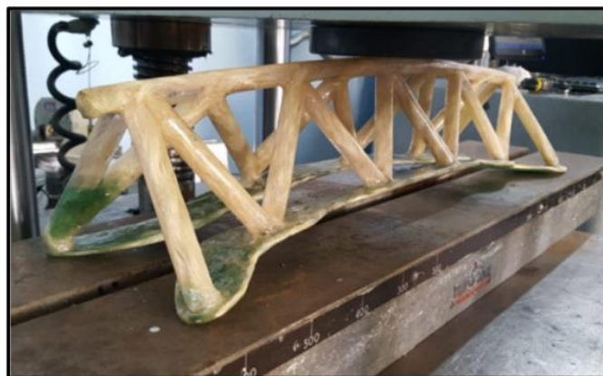
Figura 3.13. Ensayo de compresión realizado al elemento estructural (Autores)
