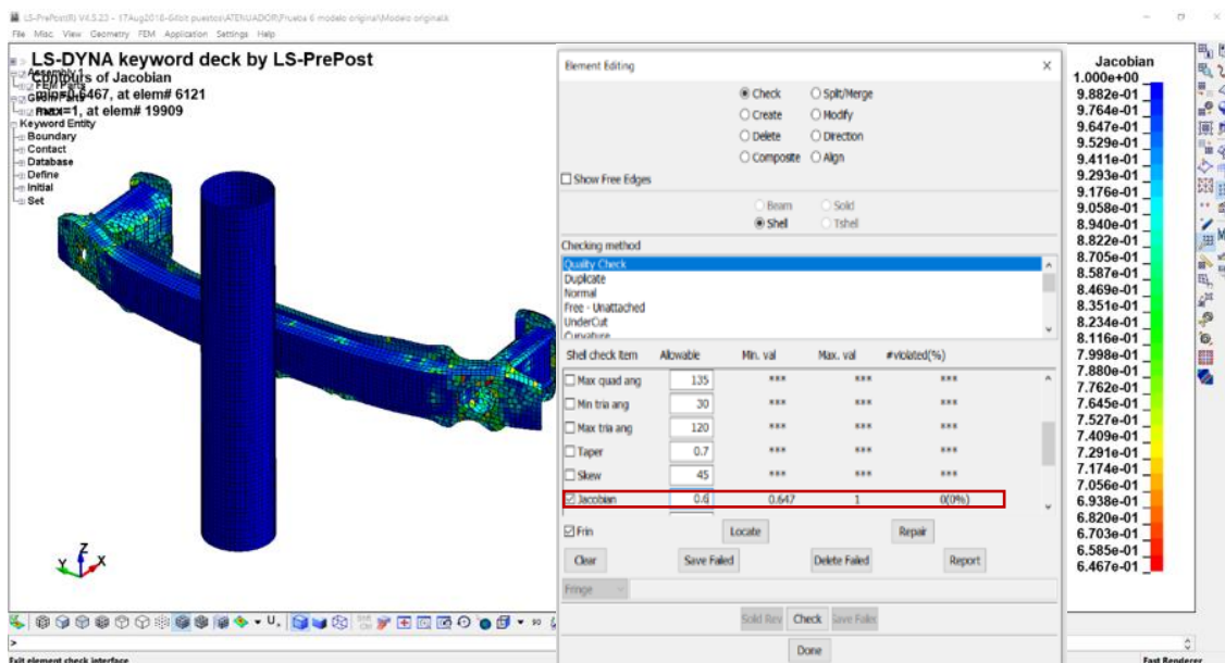
Figura 2.27. Mallado con índice de calidad Jacobiano (mín. 0.647, valor permitido mayor a 0.3) (Autores)
