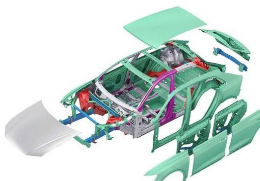
Figura 1.1. Principales componentes estructurales automotrices (FirstStop, 2019)
