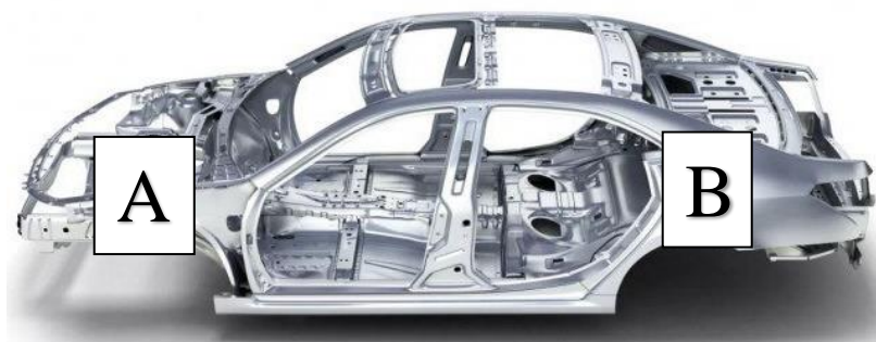
Figura 1.4. Parachoques frontal y trasero presente en una carrocería autoportante. (Mopar, 2019)
