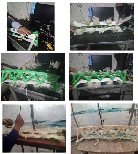
Figura 15. Proceso de construcción de la probeta para ensayo de compresión (Autores)
