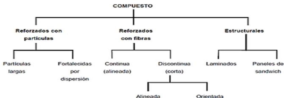
Figura 1.9. Clasificación de los materiales compuestos según el refuerzo (Espinoza et al, 2016)
