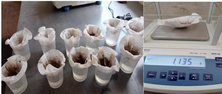
Nota: en la figura se representa el proceso de filtrado de sedimentos y el pesaje del papel filtro luego del proceso de secado.
