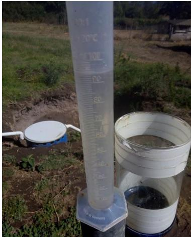
Los tanques colocados en la parte final de cada unidad experimental fueron uno de 200 l y otro de 50 l mismos que tenían una graduación para poder determinar la altura de agua escurrida obteniendo el volumen y estos datos se los transformó a porcentaje de escurrimiento superficial.
