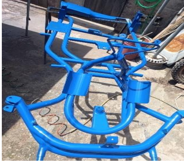
Figura 63 Proceso de pintura con poliuretano Fuente Propia
