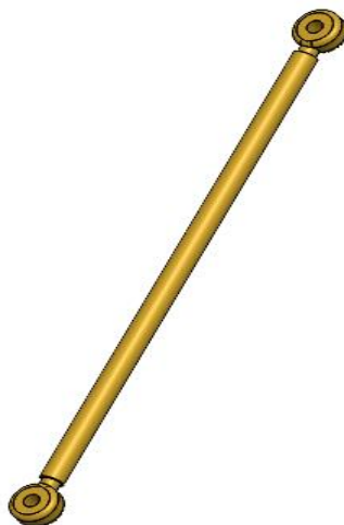
Figura 11 Varillas de dirección Fuente Propia
