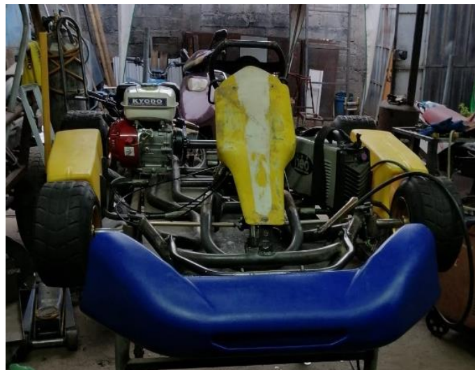
Figura 60 Montaje de plásticos de protección Fuente Propia
