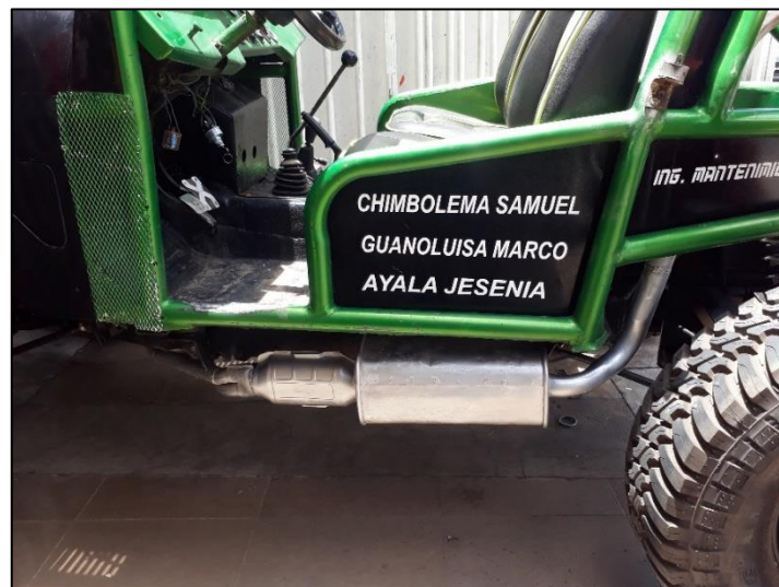
Figura 2. 5 Instalación del catalizador
