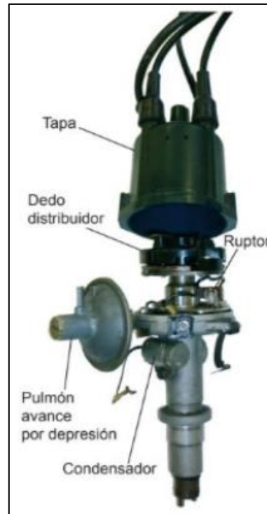
Figura 1. 4 Elementos principales en el distribuidor (Pérez, 2017, pág. 10)
