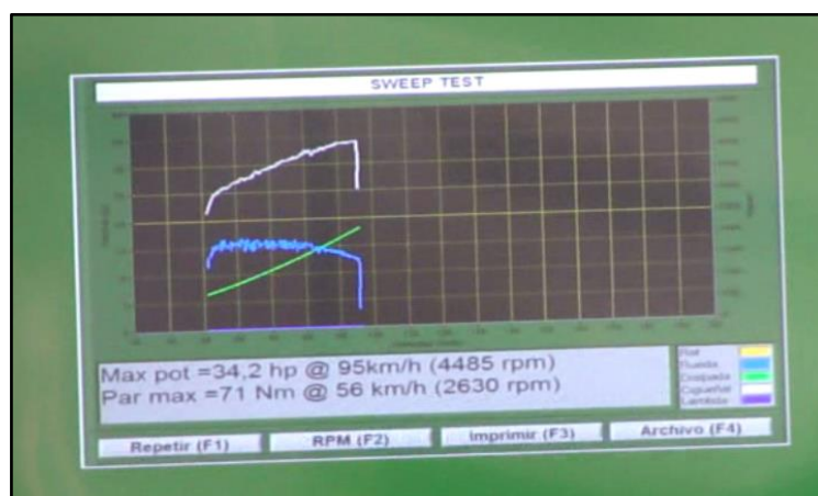
Figura 2. 9 Curvas de torque y potencia en software del dinamómetro
