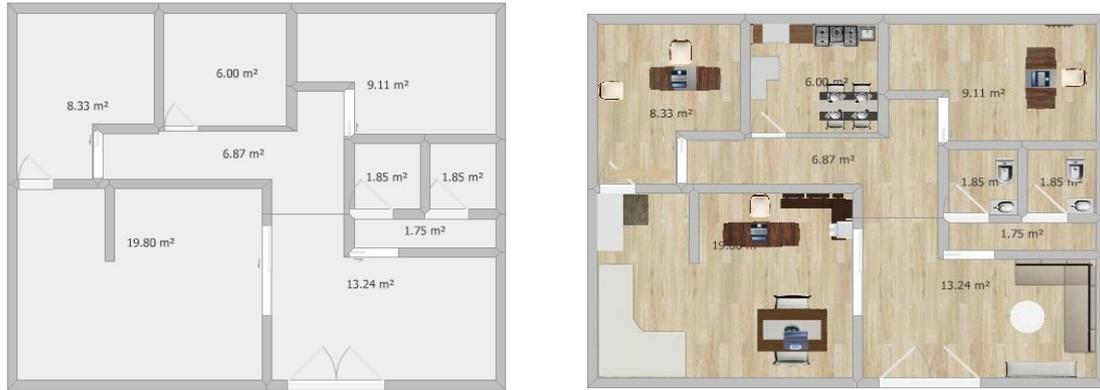
En los bocetos propuestos se refleja las medidas y las posibles áreas ubicando los cortes tanto laterales como cortes frontales y demás detalles. En la primera imagen se observa la estructura de la planta, visualizando la respectiva ubicación de las áreas. En la siguiente imagen se puede apreciar el diseño de la oficina como tal, puesto que se ubica los muebles establecidos para el funcionamiento de la operadora turística.
