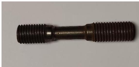
**Figura 2.32** Probeta según norma NTE INEN 2 499:2009
