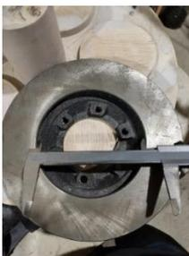
**Figura 2.12** Dimensionamiento del disco de freno
