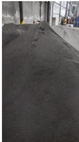
**Figura 2.4** Mezcla de Moldeo
