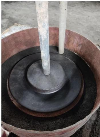
**Figura 2.26** Fabricación del molde de fundición
