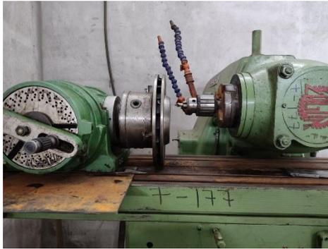
**Figura 2.30** Fresado del disco de freno
