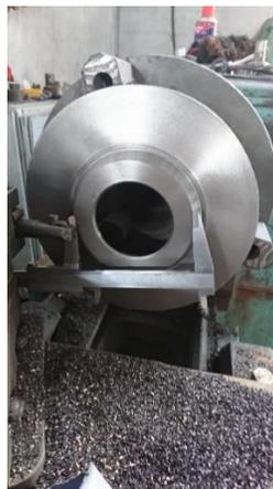
**Figura 2.29** Torneado del disco de freno
