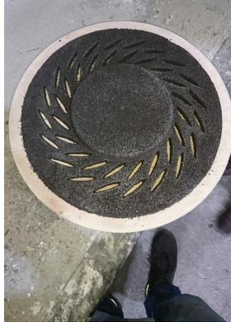
**Figura 2.27** Fabricación del noyo
