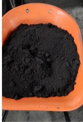
**Figura 2.25** Mezcla de moldeo
