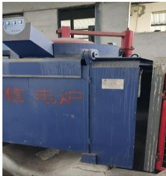
**Figura 2.7** Horno de inducción eléctrico
