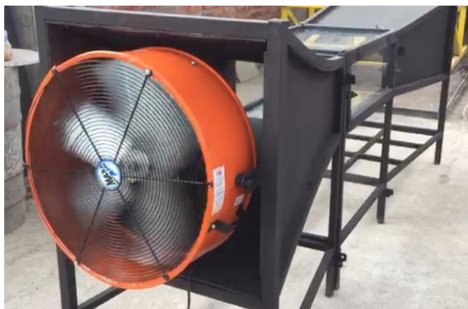
Figura 3.8 Construcción del túnel de viento
