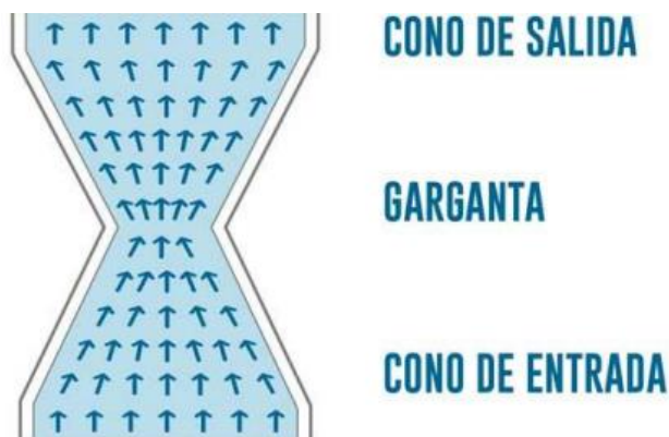
Figura 1.5 Túnel de viento vertical (Landázuri, 2016, pág. 27)
