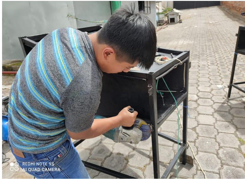
Figura AI.2. Elaboración del difusor de entrada del túnel de viento
