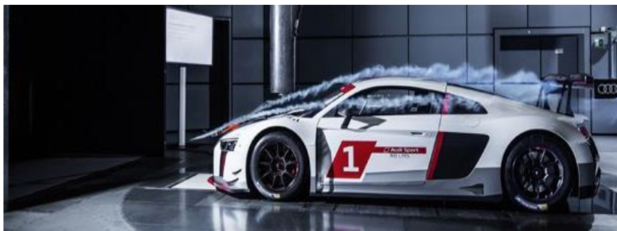
Figura 1.1 Túnel de viento de un vehículo AUDI (García, 2015)
