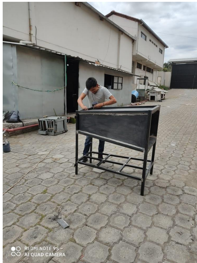
Figura AI.3. Elaboración del difusor de salida del túnel de viento
