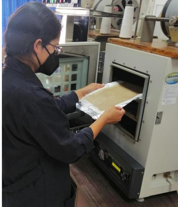
**Anexo 5.** Secado de la muestra en la estufa (Vacuum Oven)
