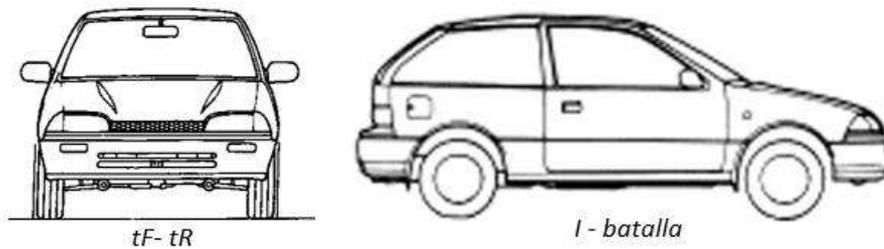
Adicionalmente se necesitó conocer la dimensión de la batalla del vehículo, que se mide desde el centro de la rueda delantera, hacia la posterior. Todos esos datos se los obtiene de blueprints del vehículo como el que se observa en la figura 2.6. También medidas respecto a la altura de la elevación del eje. La nomenclatura presentada a continuación en la tabla 2,1 corresponde a las variables a utilizar.
