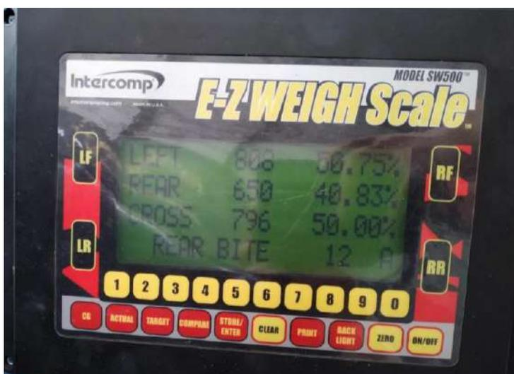
Toda medición o recopilación de datos se realizó con la maquina ajustada a cero como se evidencia en la figura 2.4 en la cual se observa la opción Zero del dispositivo y el ajuste.
