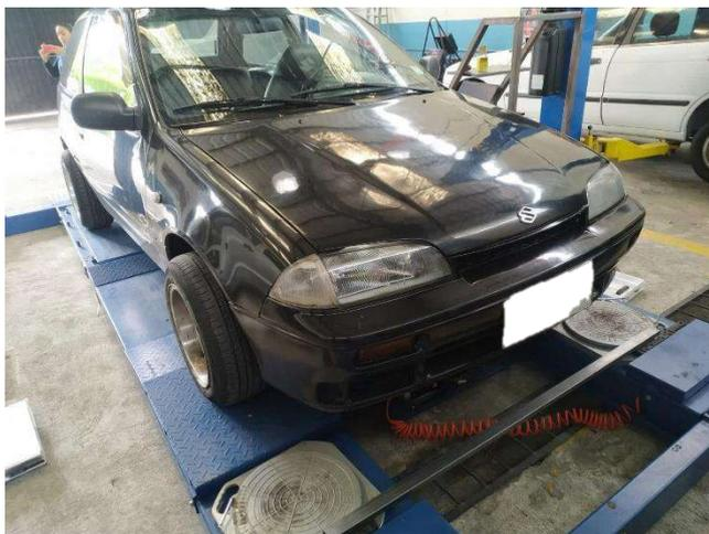
Antes de ubicar el vehículo de la figura 2.33 sobre las plataformas de pesaje, se realiza el ajuste del equipo a cero mediante las opciones de la consola. En la figura 2.33 se observa la pantalla de ajuste del equipo. El procedimiento de ajuste se especifica en el manual del fabricante.
