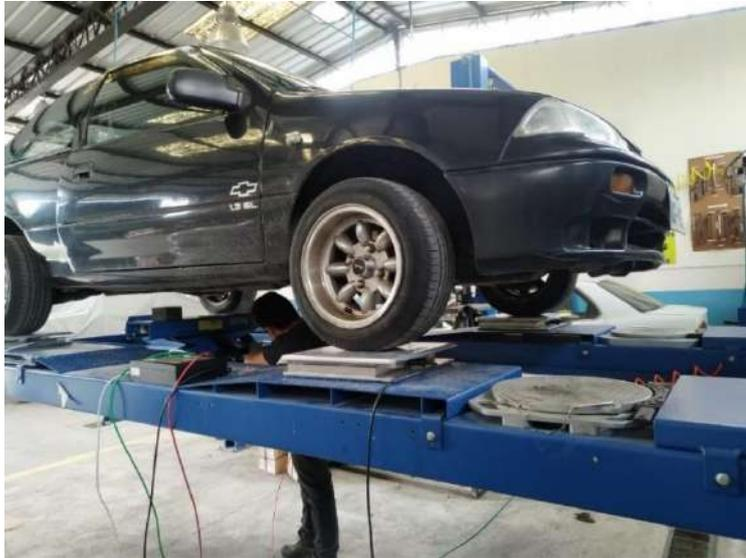
Los pesajes del vehículo se los realizó a diferentes ángulos para tomar en cuenta las variaciones del peso en el eje posterior y el ángulo de elevación del eje frontal. Datos que tienen presencia para el cálculo de posición del centro de gravedad. En la tabla 2.4 se observa el peso de cada rueda del eje delantero y posterior, respecto al ángulo de inclinación al que se somete el vehículo.
