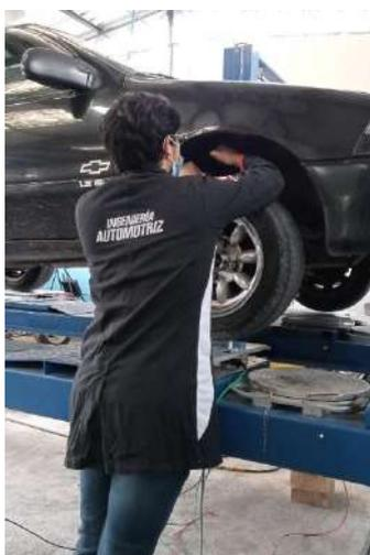
La regulación de coilovers se la realiza con el fin de asignar una distribución de peso cruzado proporcional, para lo cual se realiza la regulación como en la figura 2.38 y se pesa el vehículo hasta obtener los valores cruzados de 50%.
