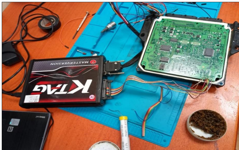
Figura 2.14 Conexión física de pines al circuito impreso camioneta Nissan
