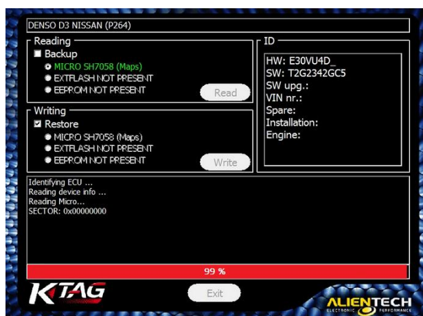
Figura 2.17 Lectura de la memoria (Captura tomada del equipo K-Tag)
