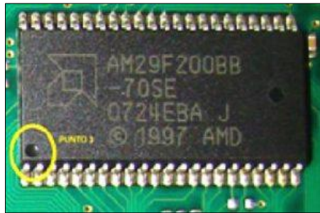
Figura 1.10 Memoria tipo SOP (Auto Avance , 2013)
