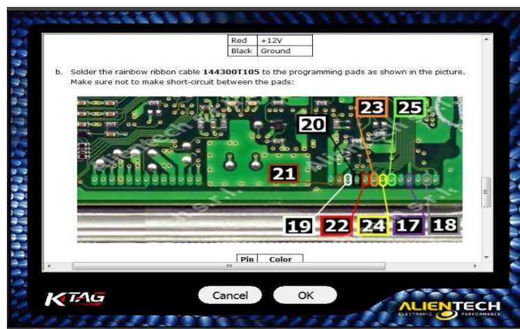
Figura 2.13 Conexión de pines al circuito impreso (Captura tomada del equipo K-Tag)
