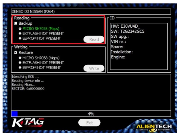
Figura 2.15 Identificación del tipo de microcontrolador SH7058 (Captura tomada del equipo K-Tag)
