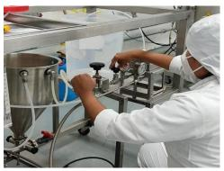
Figura 15. Apertura de las válvulas del sistema al finalizar el trabajo en el equipo.
