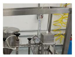
Figura 17. Recuperación del permeado de lactosa a través del equipo de filtración tangencial.
