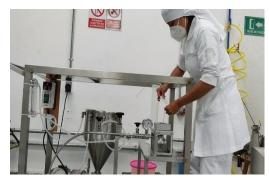
Figura 13. Colocación de la membrana plana de microfiltración.
