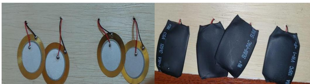
Figura 19. Prototipo ubicación con recubierto termo retráctil
