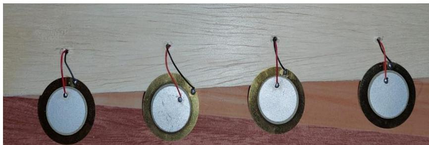
Figura 21. Generador piezoeléctrico con recubrimiento impermeable
