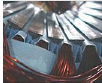
Figura 14. Aislamiento del devanado.
